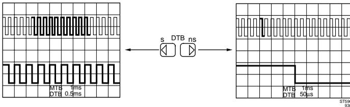
**DELAYED TIMEBASE****TRACE SEPARATION**
